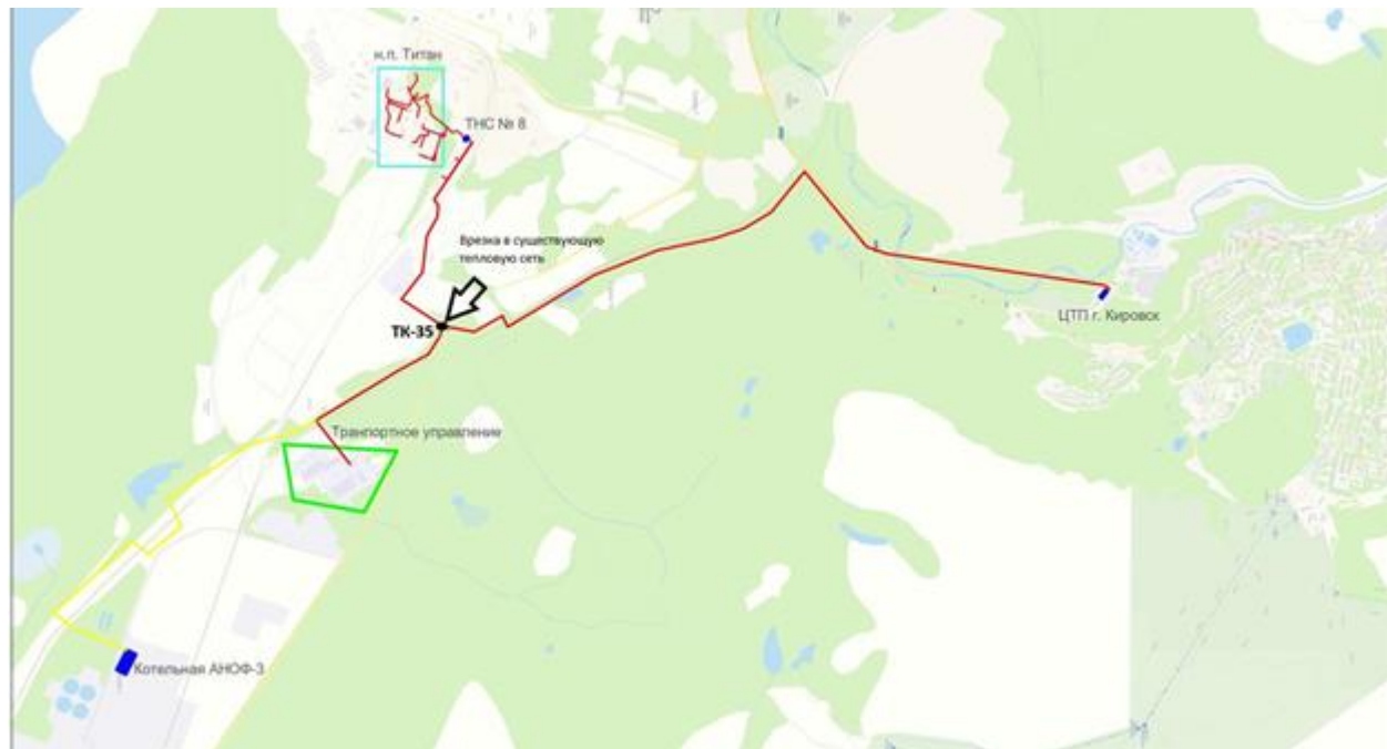
Рисунок 15 - Предлагаемая схема прокладки тепломагистрали до н.п. Титан
