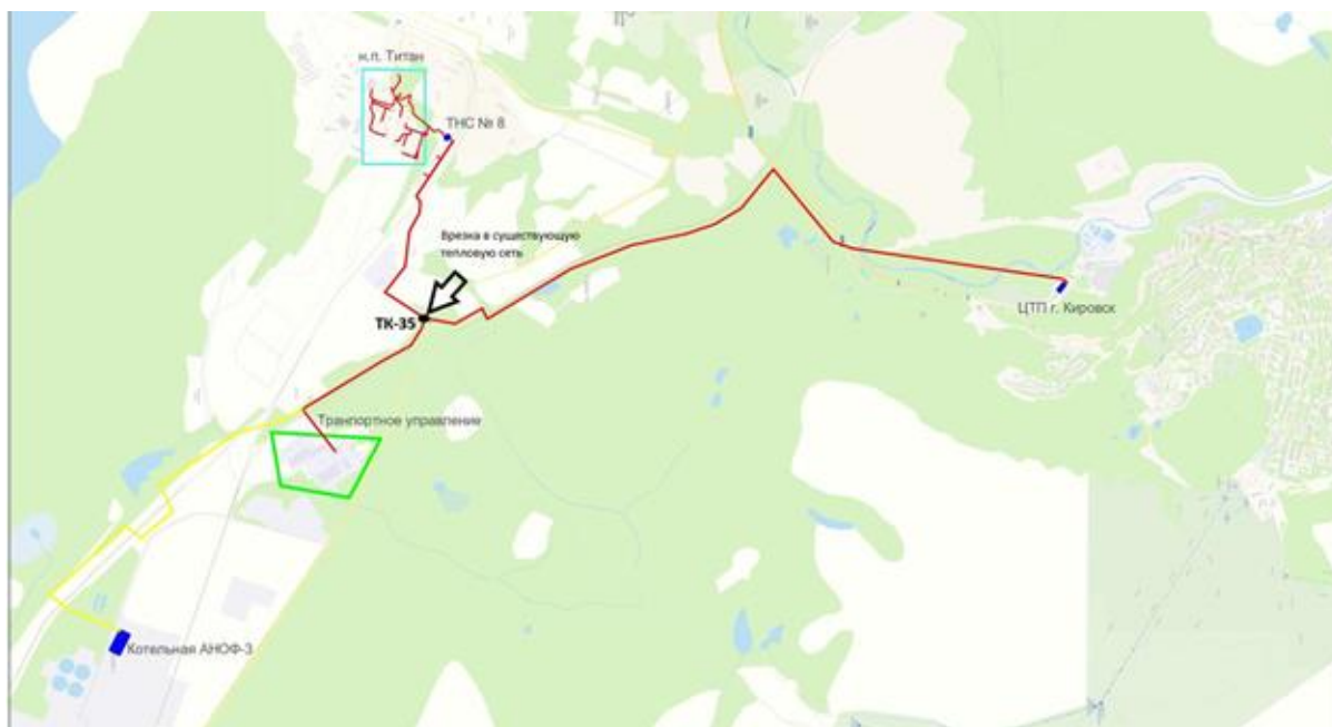
Рисунок 5 - Предлагаемая схема прокладки тепломагистральной до н.п. Титан
