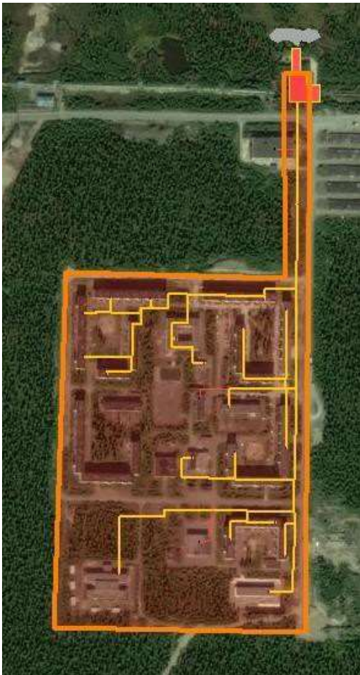
Рисунок 11.4.8 Зона теплоснабжения электрической БМК н.п. Коашва
