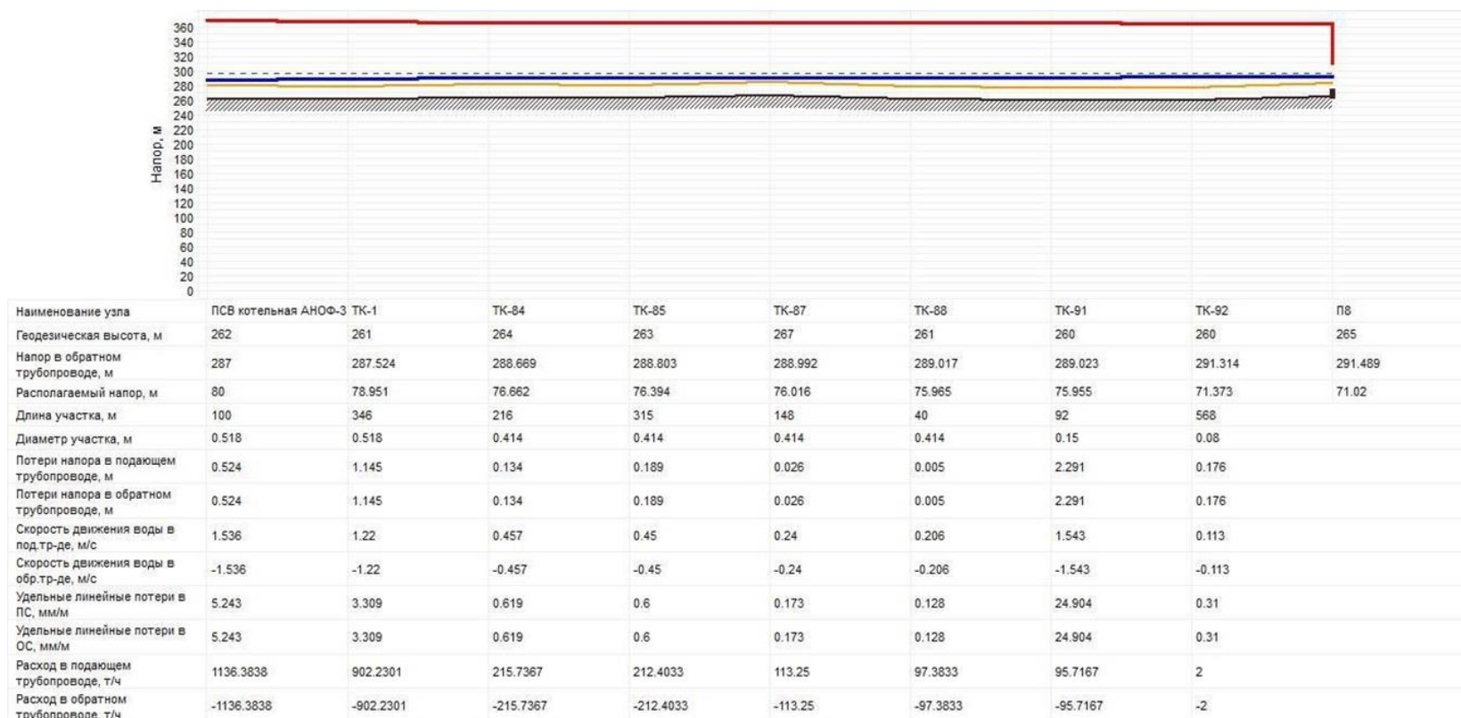
Рисунок 10 - Пьезометрический график от котельной АНОФ-3 до промзоны
