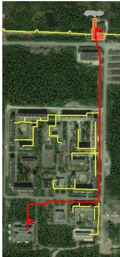
Рисунок 39 - Направление №1 от электрической БМК н.п. Кошва
