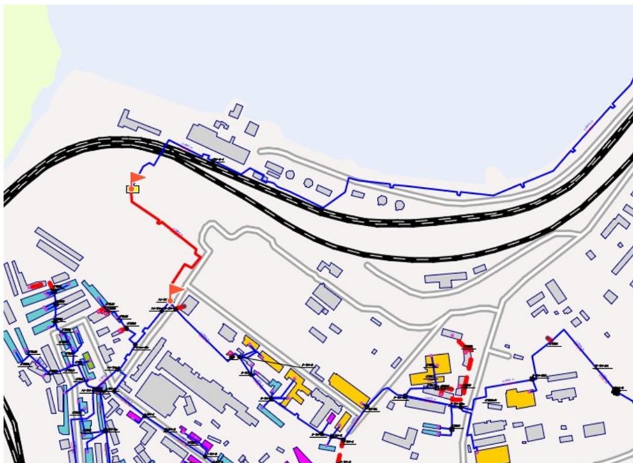
Рисунок 20 - Участок трубопровода тепловой сети от 4-ТК-1а до ТК-0-1
