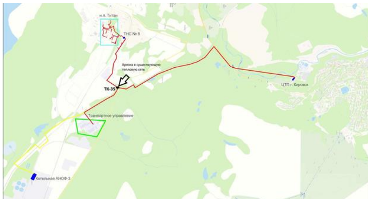
Рисунок 5 - Предлагаемая схема прокладки тепломагистрали до н.п. Титан
