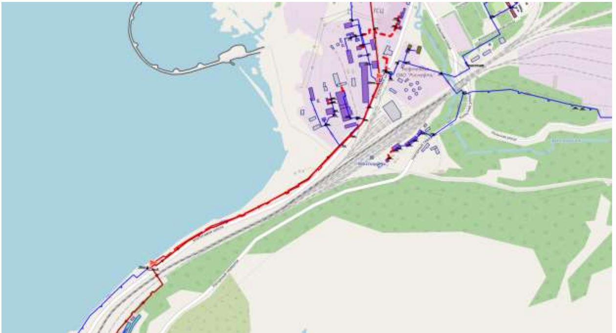
Рисунок 8.9.1 - Модернизация участка трубопровода тепловой сети между ПАВ №4а и ПАВ №3. Заменен участок протяженностью 1,9 км тепловой сети
