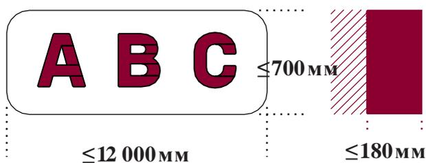
Световой короб простой геометрической формы. Для его внутренней подсветки используются светодиоды.
