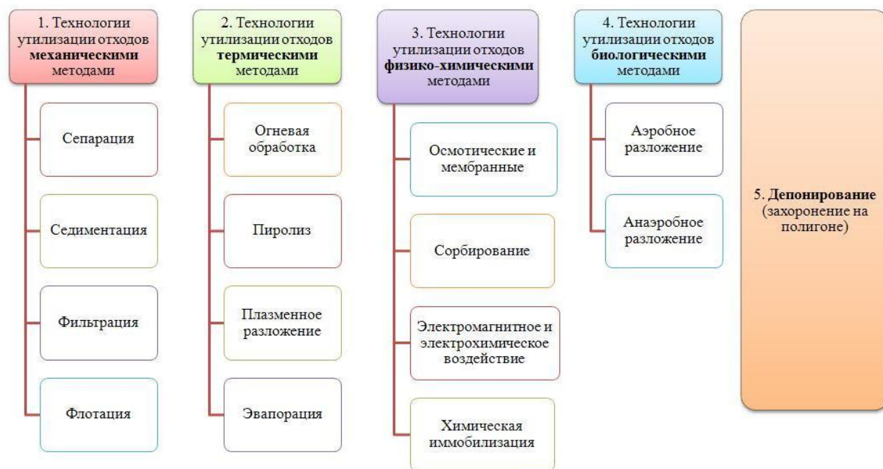
Рисунок 1.59 — Принципиальная схема-классификация известных технологий утилизации и обезвреживания отходов производства и потребления [25]
