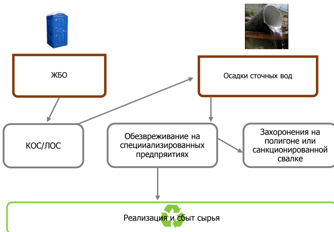
Рисунок 3.10 – Схема движения потоков ЖБО
