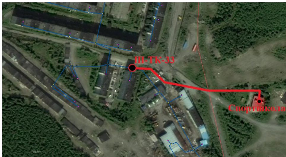
Рисунок 5.4.2 Схема переподключения абонента «Спортшкола» К началу 2017 года данное мероприятие было полностью реализовано.
