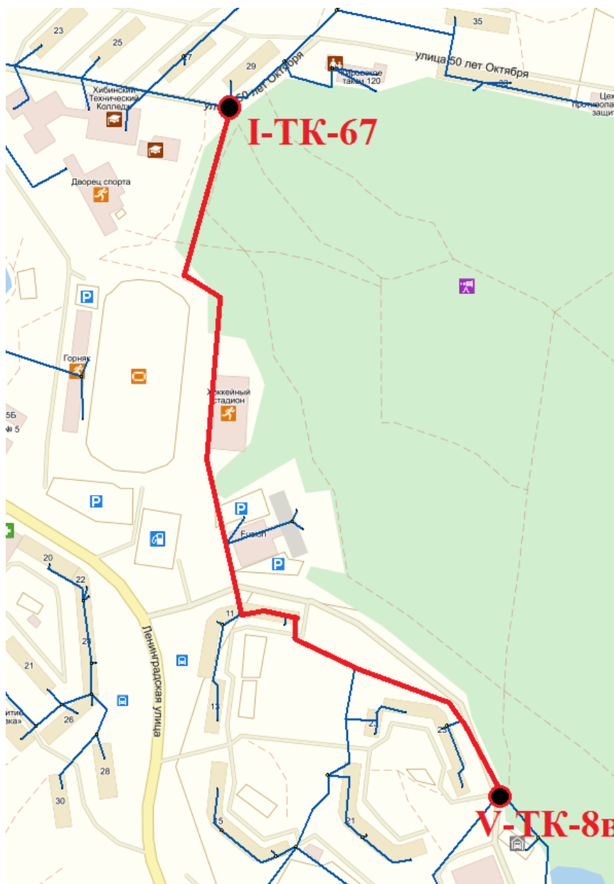
Рисунок 5.4.3 Схема предлагаемого к реконструкции участка тепловой сети К началу 2017 г. мероприятие частично реализовано на участке от V-ТК-8в до V-ТК-17.
