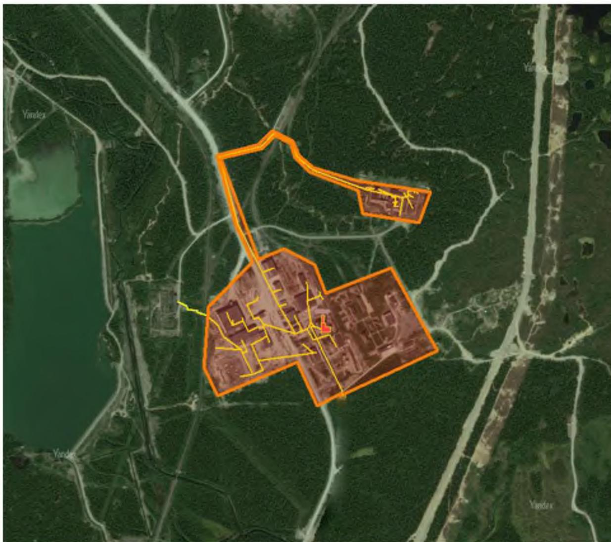
Рисунок 2.17 Зона действия системы теплоснабжения от промышленной блочно-модульной котельной Восточного рудника
