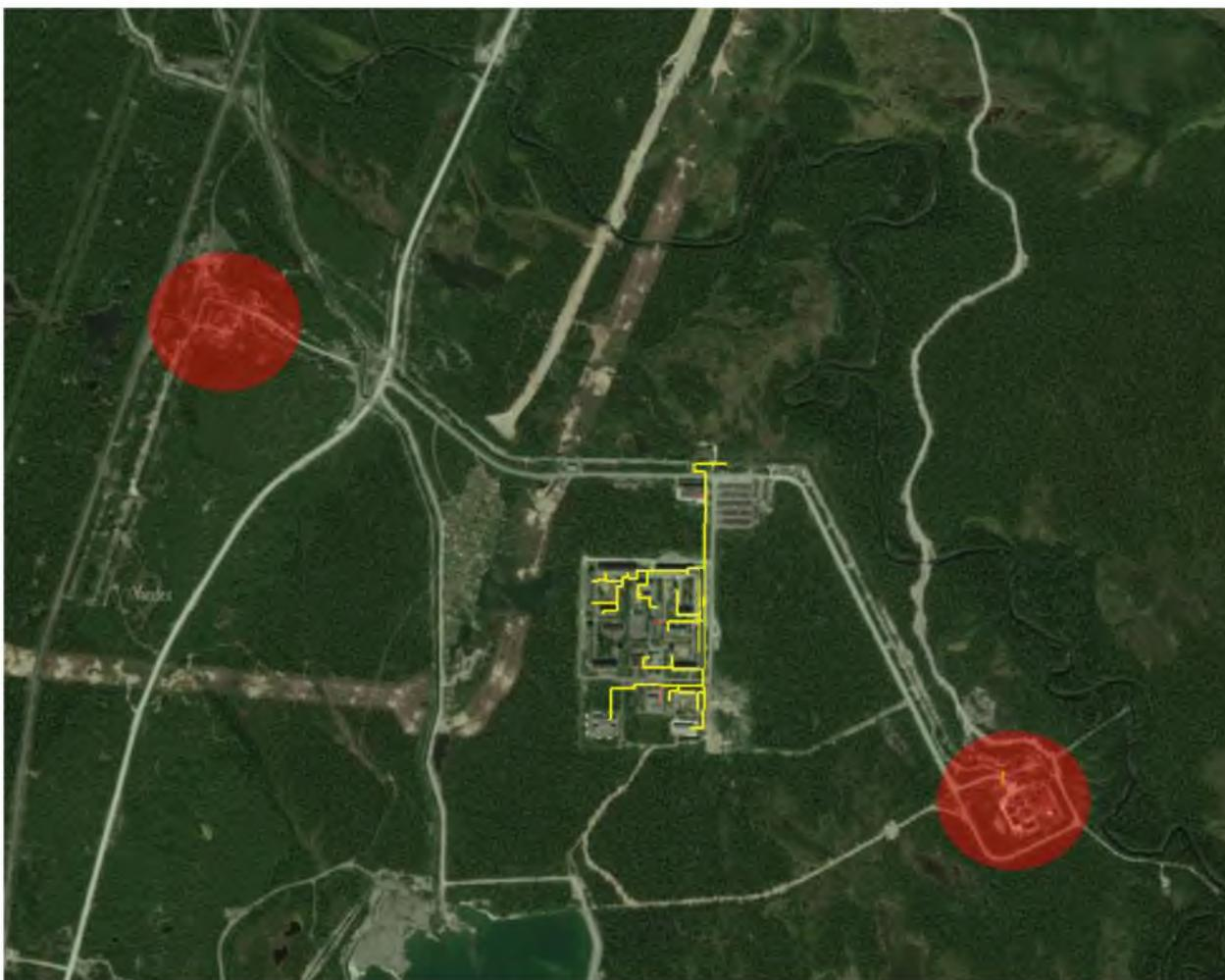
Рисунок 2.18 Зоны действия индивидуальных источников теплоснабжения
