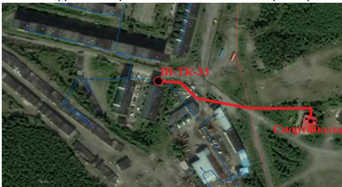
Рисунок 5.2 Схема переподключения абонента «Спортшкола»
