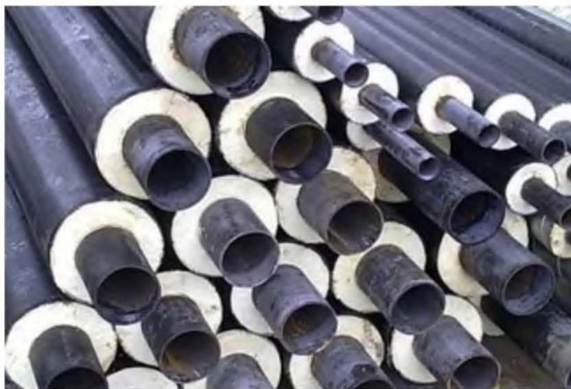
Рисунок 5.7 Предизолированные трубопроводы
