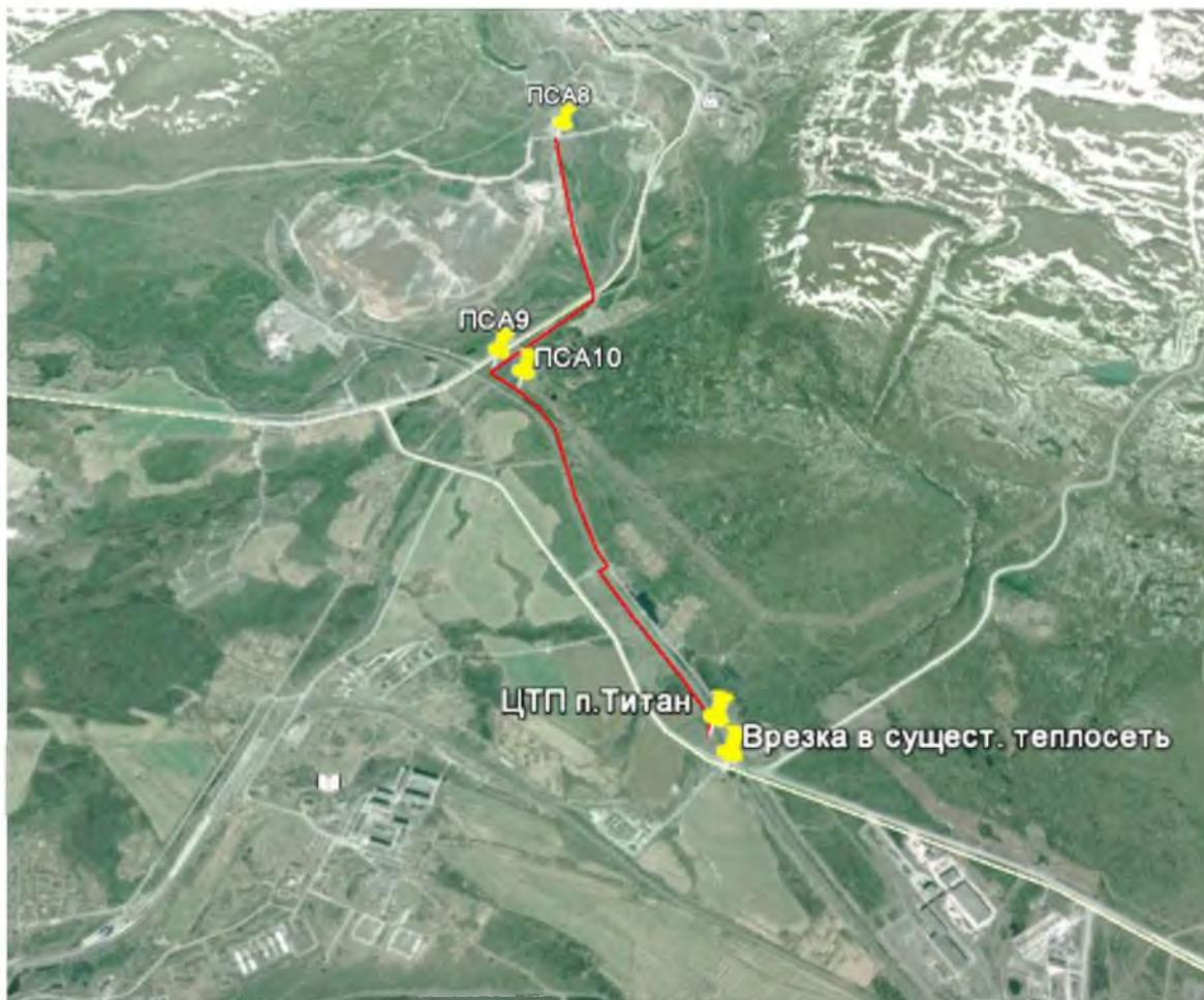
Рисунок 4.1 Предлагаемая схема прокладки тепломагистрали до н.п. Титан
