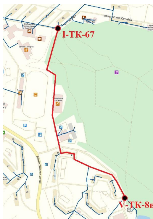
Рисунок 5.4.3 Схема предлагаемого к реконструкции участка тепловой сети
