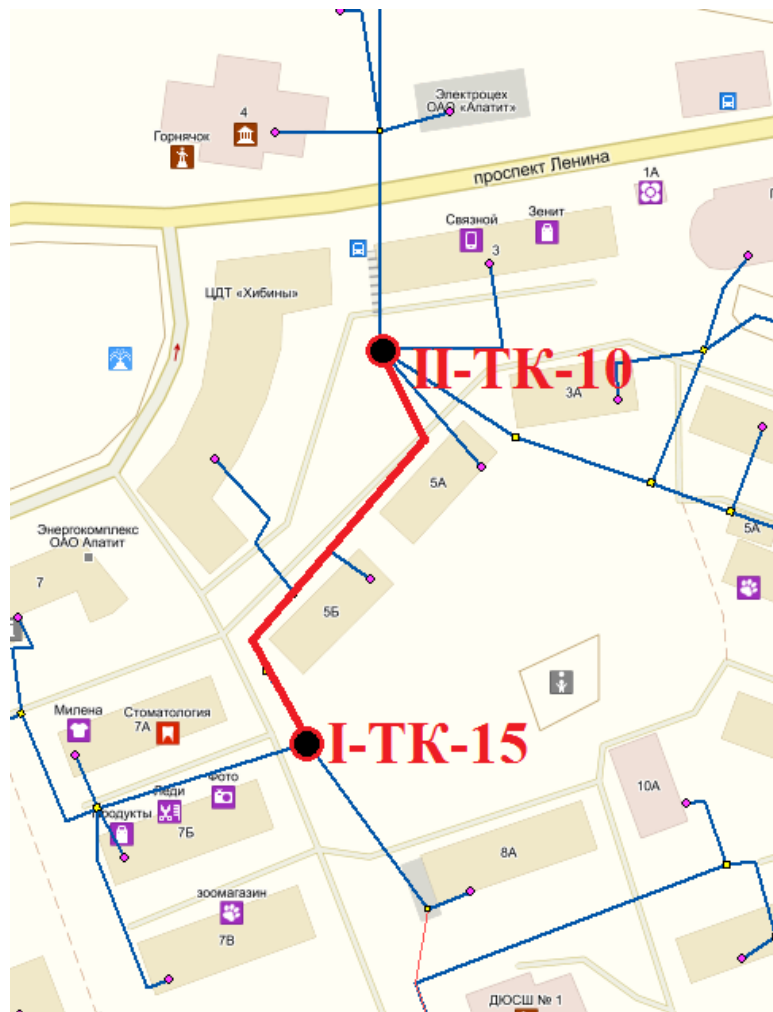
Рисунок 5.4.4 Схема предлагаемого к реконструкции участка тепловой сети Реализация мероприятия планируется в 2018 г.
