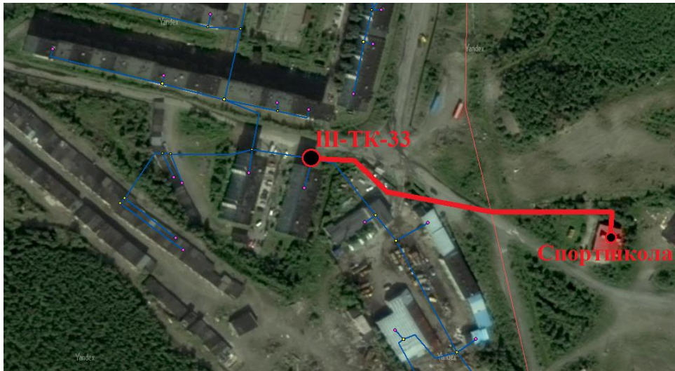
Рисунок 5.4.2 Схема переподключения абонента «Спортшкола»
