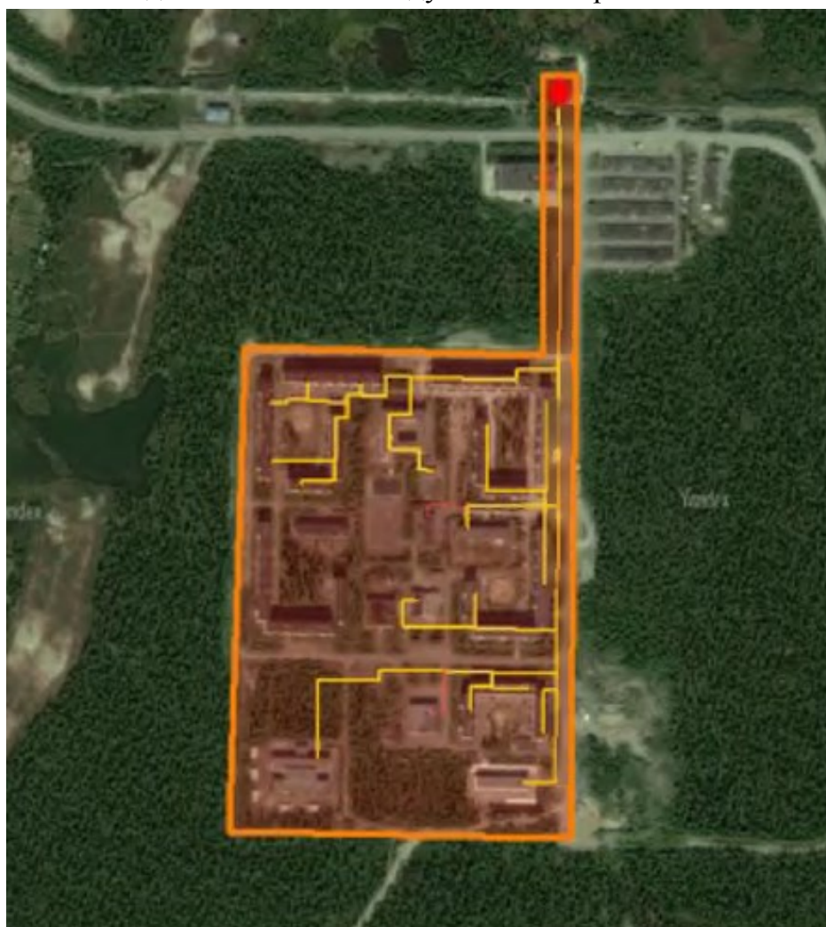
Рисунок 2.16 Зона действия блочно-модульной электростанции н.п. Коашва
